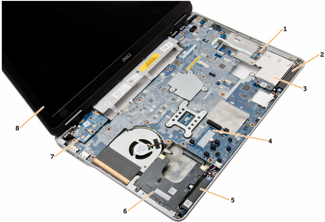
그림 2. 상단 모습 — 키보드 및 손목 받침대 어셈블리 분리
